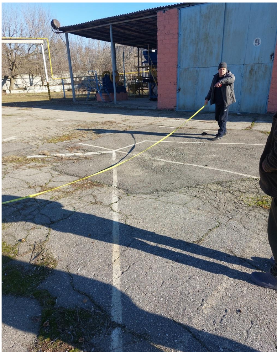
Рисунок 4.3 – Процес вимірювання радіусу повороту самохідного шасі під час проведення експериментальних досліджень
