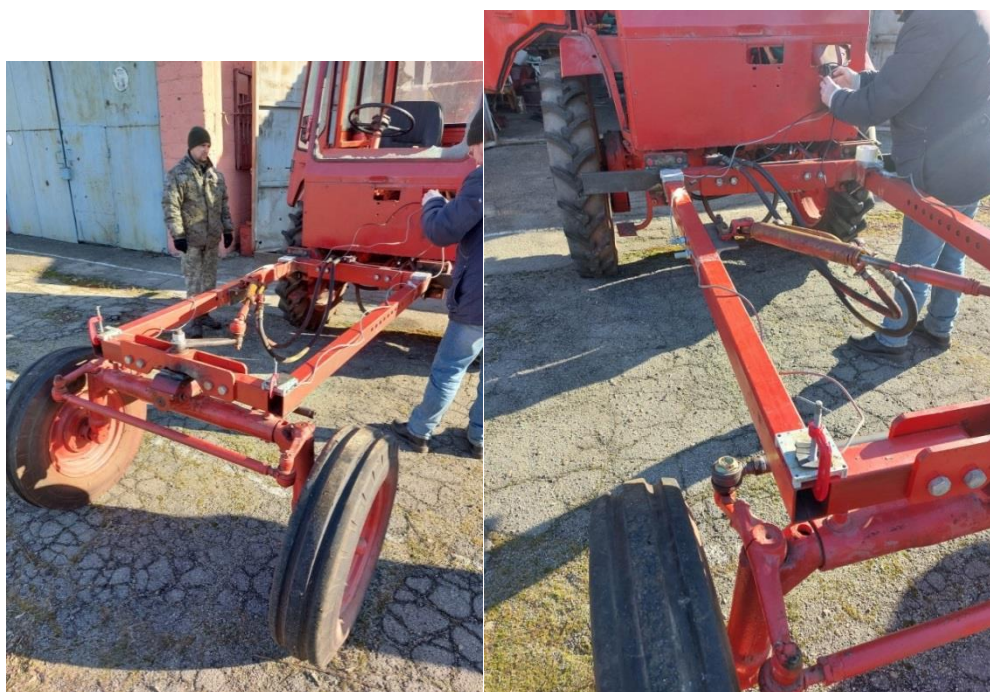
Рисунок 4.5 – Встановлення трьохкоординатних датчиків прискорення Freescale Semiconductor моделі MMA7260QT на самохідне шасі Т-16МГ: а – на серійній машині; б – на модернізованій машині
