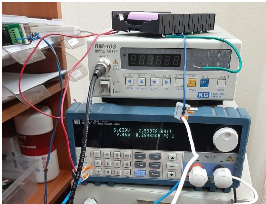
Рисунок 2.16 – Випробувальний стенд, на якому отримані зарядно - розрядні характеристики літій-іонної батареї
