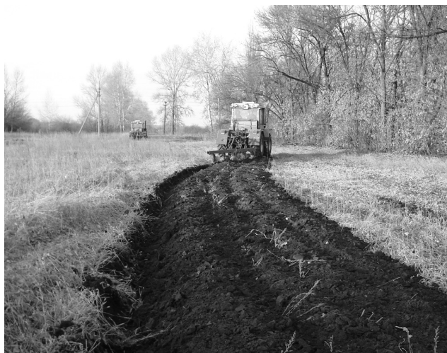
Рисунок 5.1 – Увід трактора ХТЗ-17221 на орних роботах від прямолінійного руху без впливу тракториста за коефіцієнту об'ємної подачі гідрооб'ємного рульового керування K_Q=0,7
