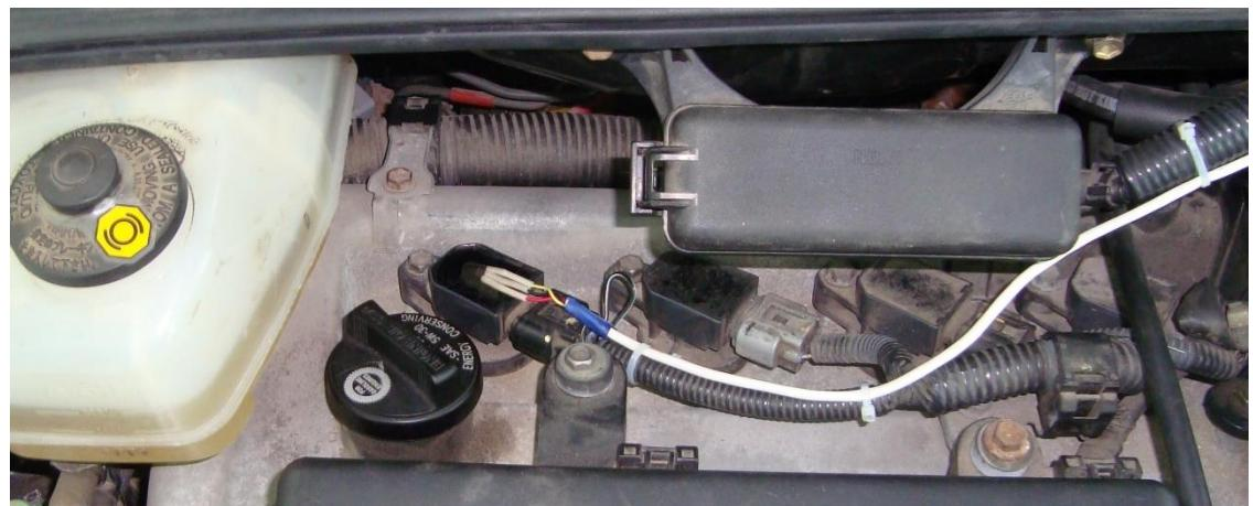
Рисунок 4.7 – Датчик тахометра ДВЗ
