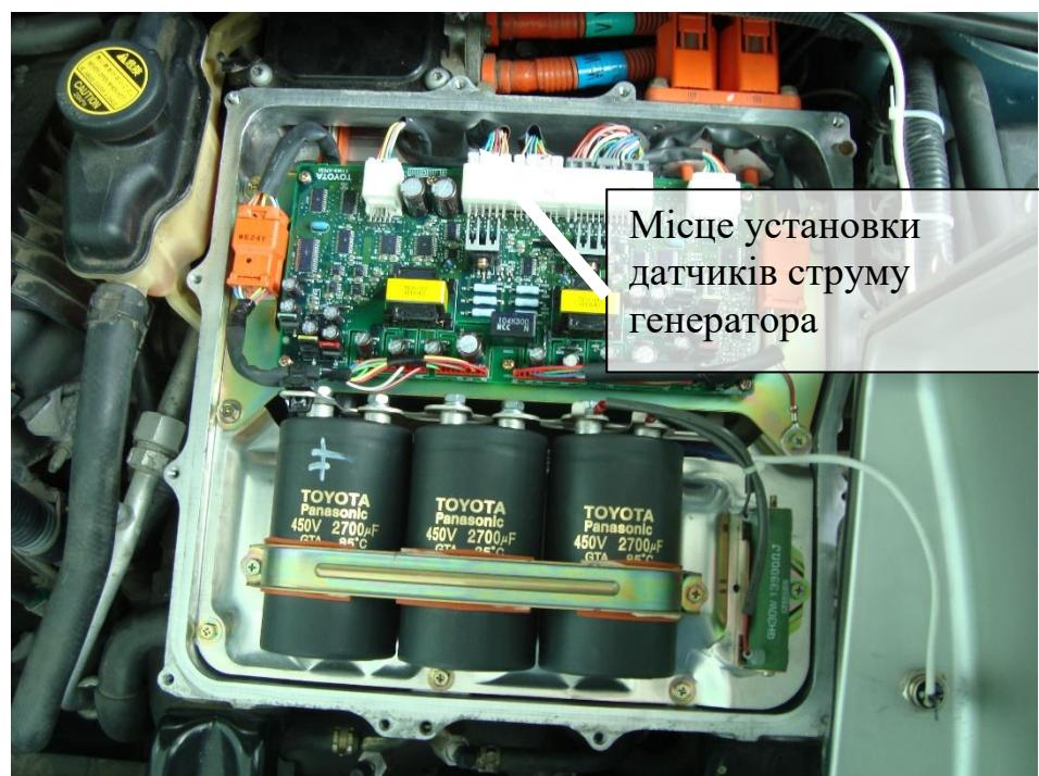
Рисунок 4.3 – Місце встановлення датчиків струму
