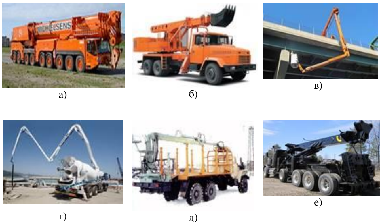
Рисунок 1.2 – Різновиди підйимально-транспортних колісних машин: а) автомобільний кран вантажопідйомністю до 700т на 9-вісному шасі; б) екскаватор-планувальник, змонтований на шасі автомобіля КраЗ; в) телескопічна вишка з радіусом дії 80 м; г) п'ятисекційний автобетононасос; д) лісовоз з гідроманіпуляторами на шасі автомобіля КраЗ; е) автомобільний евакуатор для особливо важких евакуаційних робіт
