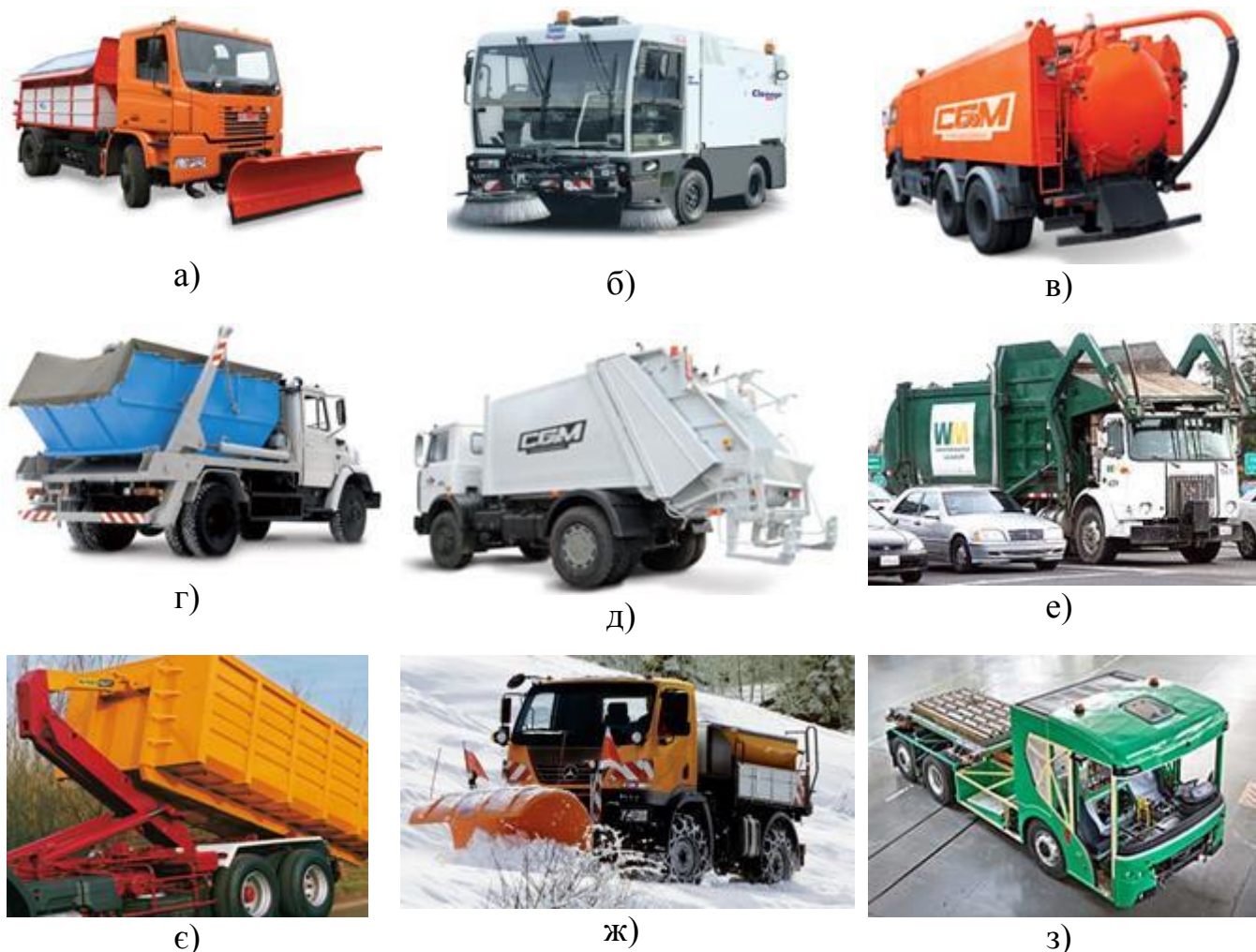
Рисунок 1.3 – Комунальна техніка: а) солерозкидувальна МДКЗ, б) для ямкового ремонту УЯР-01, в) муловикачувальна КО-503ІВ, смітєвози г) порталний і д) з заднім і е) переднім завантаження, є) контейнеровоз, ж) снігоприбиральна UNOMOG, з) багатофункціональна електровантажівка ВАНКЕ
