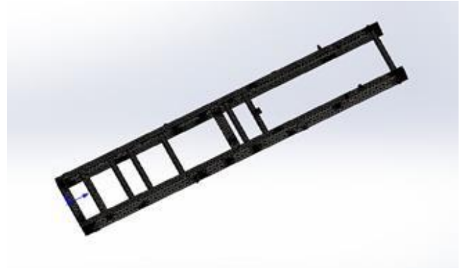
Рисунок 7.10 – Рама УТМ зі створеною сіткою
