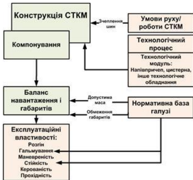
Рисунок 3.2 – Структура формування масогабаритних характеристик САТКГМ.
