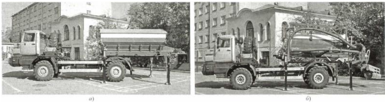
Рисунок 3.16 – Перевірка технології зняття і установки на шасі надбудов СТА-5ТМ (а) і СТА-5ЖО (б)
