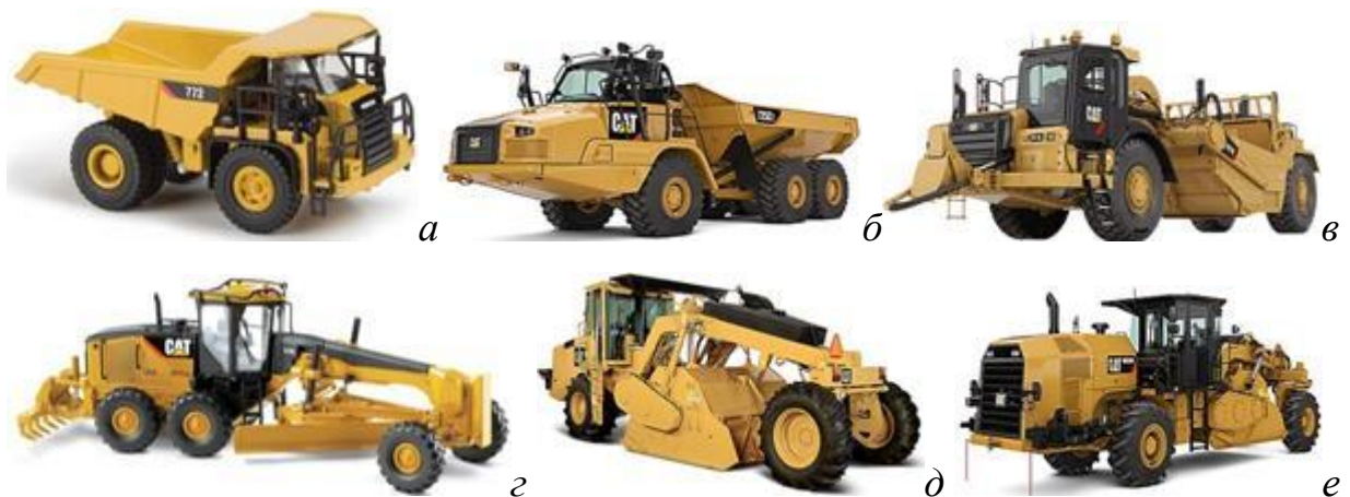
Рисунок 1.1 – Дорожньо-будівельна техніка компанії CAT: а) самоскид з жорсткою рамою моделі 772, б) самоскид з шарнірно-зчленованою рамою моделі 725C2, в) скрепер CAT 627H, г) автогрейдер CAT 14M, стабілізатори ґрунту моделі RM300- д) і моделі RM500B - е)
