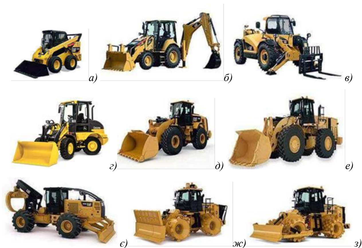
Рисунок 1.4 – Навантажувачі: а) компактний з бортовим поворотом, б) екскаватор, в) з телескопічною стрілою, фронтальні: г) малий, д) середній, е) великий, є) лісозаготовлювач, уцінювачі: сміття ж), ґрунту з)
