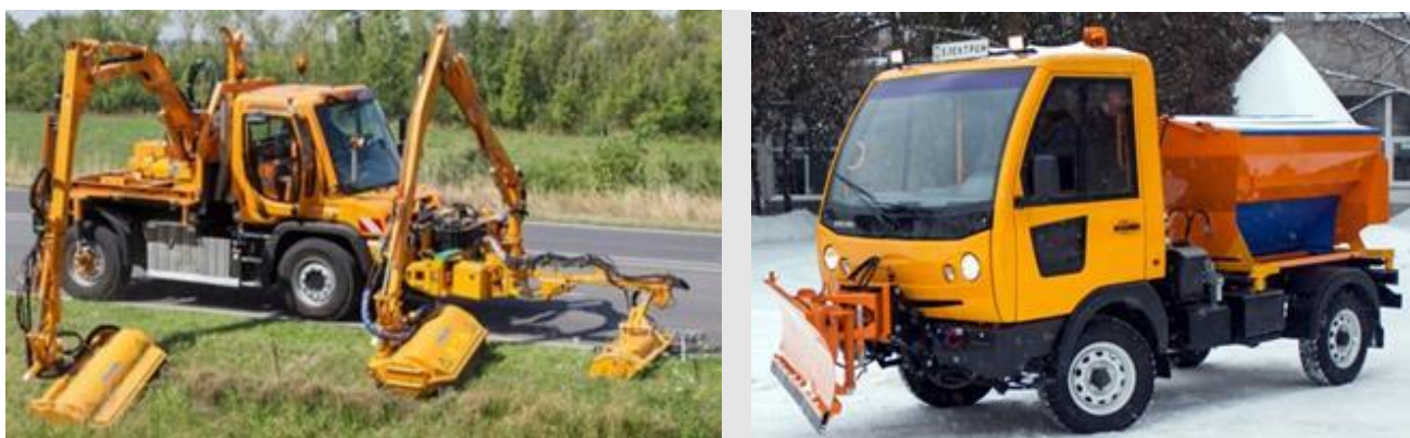
Рисунок 2.15 – Приклади УТМ – мультифункціональних повнопривідних середньотоннажних вантажівок: Unimog; EM-C320 «Електрон»
