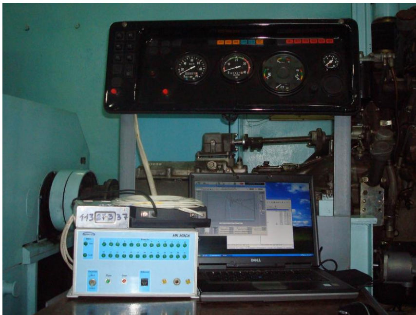
Рисунок 2.10 – Щиток контрольних приладів двигуна
