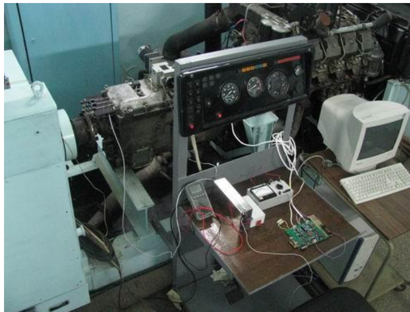
Рисунок 2.21 – Обладнання робочого місця оператора з вимірювальними пристроями на стенді
