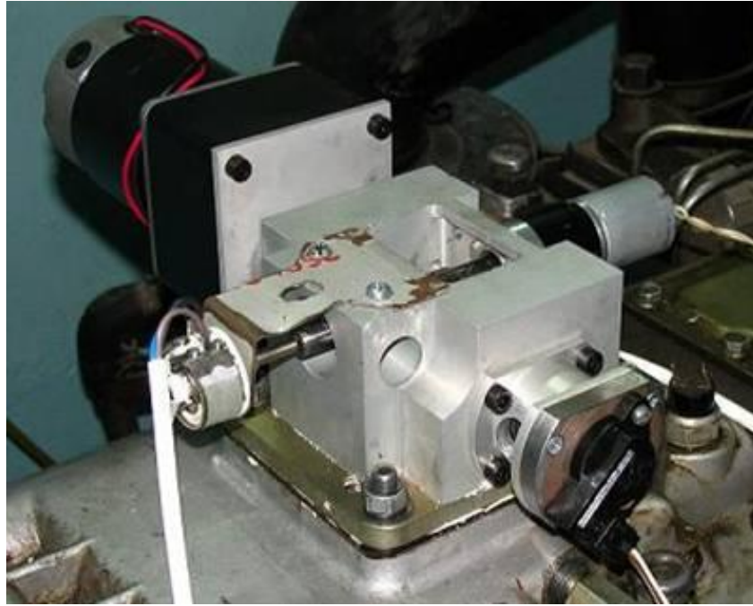
Рисунок 2.3 – Дослідний механізм автоматизованого перемикання передач змонтований на коробці передач
