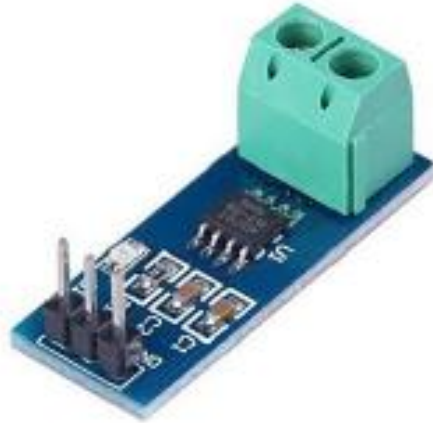
Рисунок 2.14 – Загальний вигляд модуля вимірювання струму ACS712–30A–Module
