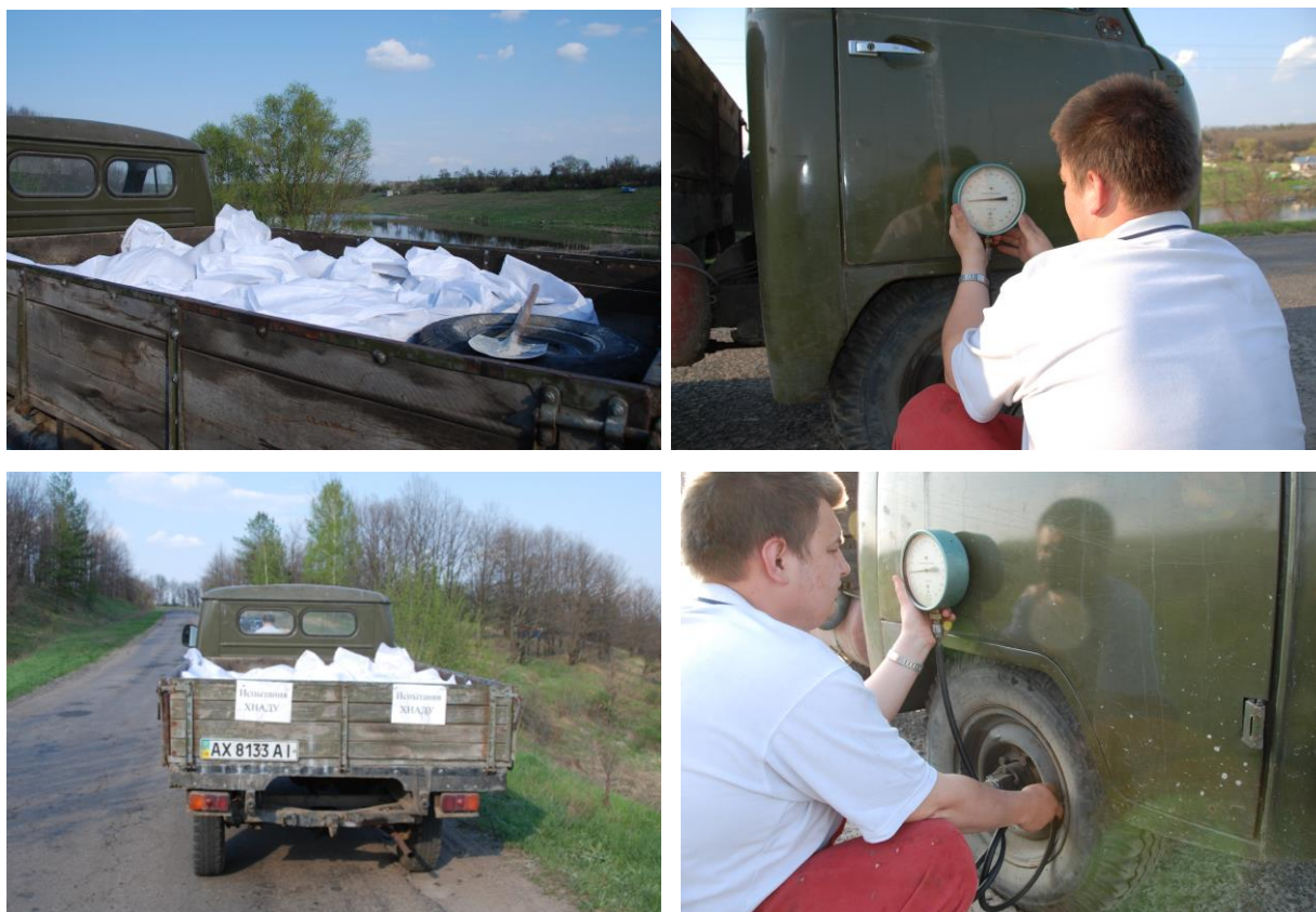
Рисунок 4.5 – Змiна варiйованих параметрiв в процесi проведення експериментальних дослiджень: а – маси вантажу; б – тиску в шинах
