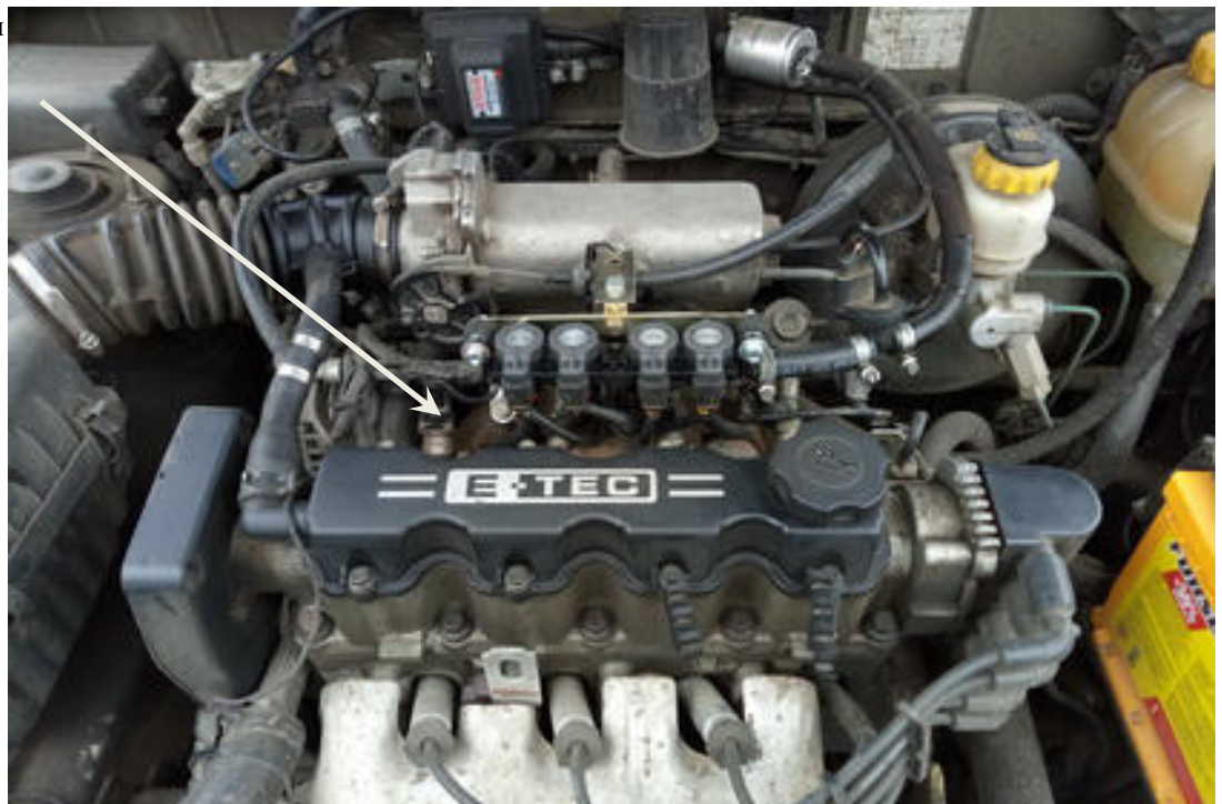
Рисунок 3.8 – Відключення подачі палива до циліндра двигуна автомобіля Daewoo Lanos 1.5i
