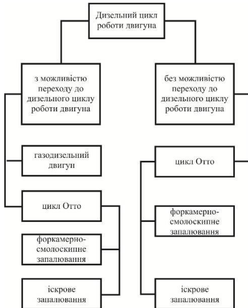
Рисунок 1.4 – Способи конвертування дизеля в газовий двигун
