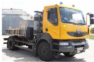
Рисунок 6.19 – Автомобіль КрАЗ-5401К2 з газовим двигуном ЯМЗ-5362Г [253], обладнаний вітчизняною конвертованою газопаливною апаратурою (Euro-4)
