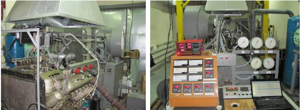
Рисунок 4.2 – Загальний вигляд експериментального стенду з пультом управління для випробувань газових ДВЗ з ГТН ( a ) і комплексом АСДД ( б )
