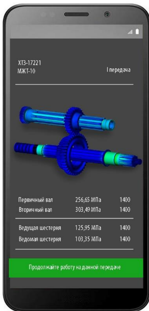
Рисунок 6.30 – Загальний вигляд вікна програми для управління транспортно-технологічним агрегатом змінної маси
