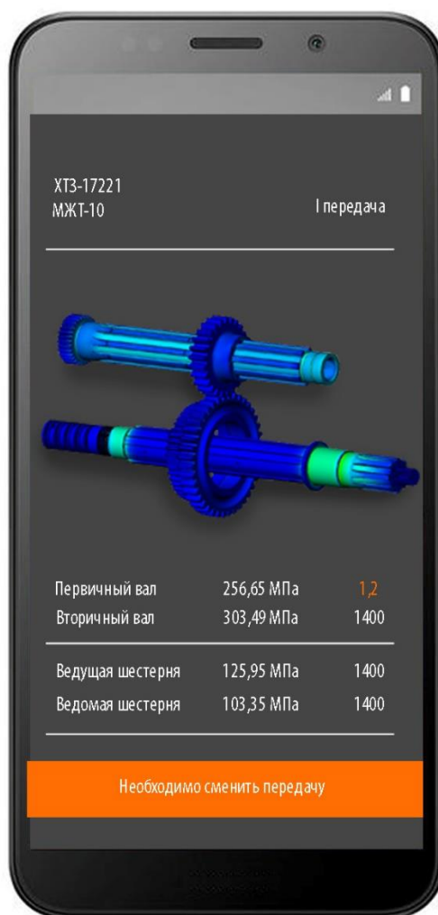
Рисунок 6.31 – Загальний вигляд вікна програми для управління транспортно-технологічним агрегатом змінної маси при перевантаженні трансмісійної установки
