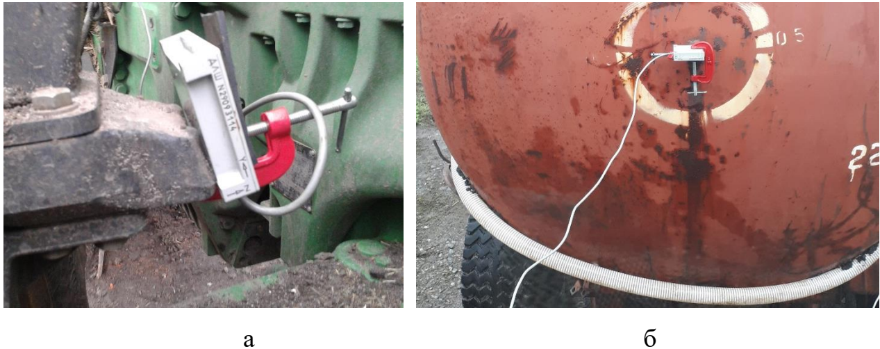
Рисунок 6.16 – Встановлення датчика прискорень на тракторі (а) і на транспортно-технологічній машині (б)
