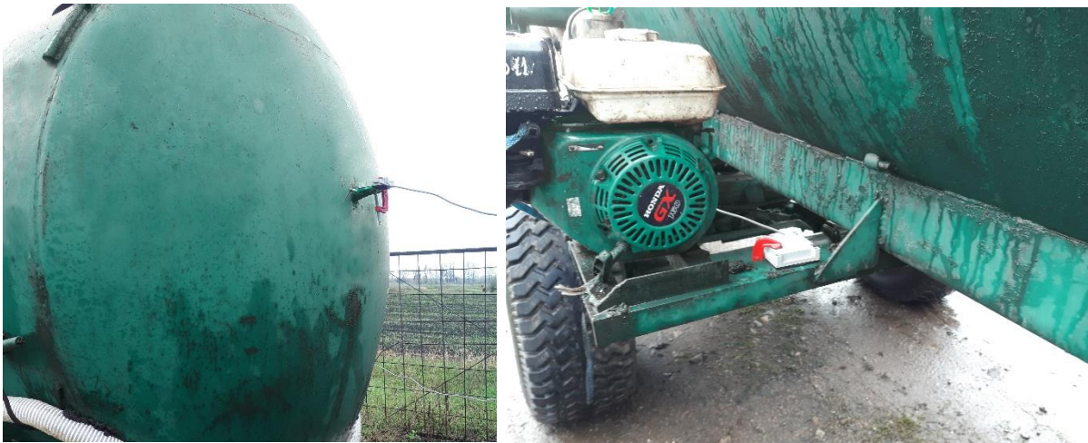
Рисунок 6.11 – Встановлення двох акселерометрів на транспортно-технологічній машині МЖТ-10
