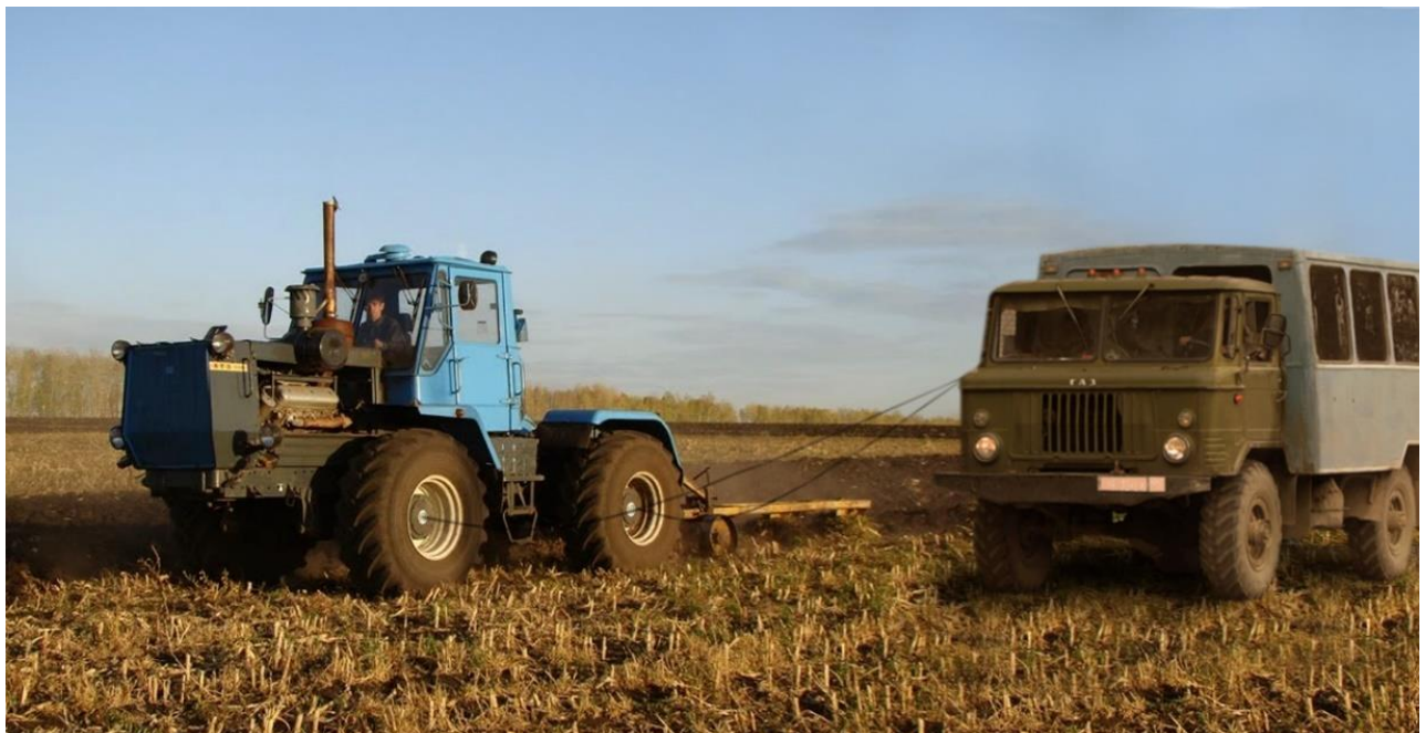
Рисунок 6.28 – Польові тензометричні випробування агрегату ХТЗ-150К + ПЛП-6-35
