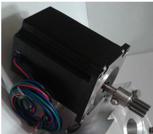
Рисунок 4.8 – Кроковий електричний двигун керування пропорційним модулятором ЕППП
