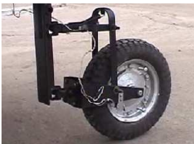
Рисунок 2.16 – Установка індукційного датчика «п'ятого колеса»
