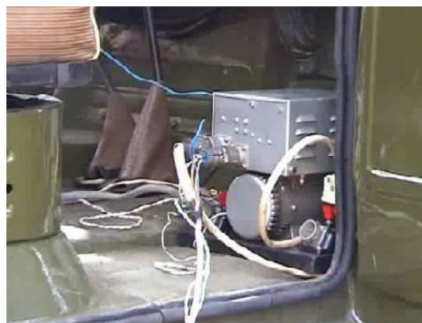
Рисунок 2.18 – Установка перетворювача струму в кабіні автомобіля
