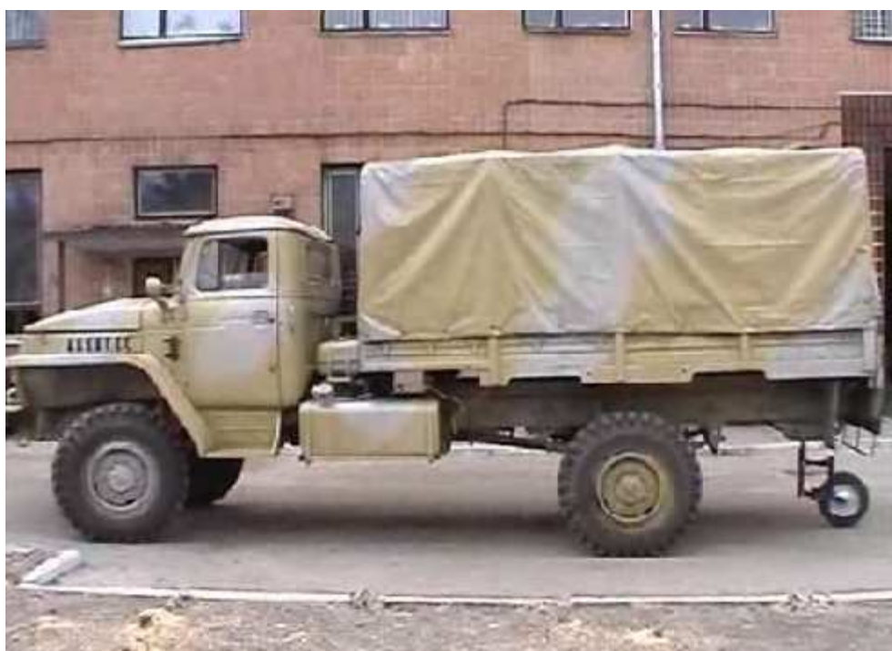
Рисунок 2.15 – Двовісна модифікація автомобіля Урал-4320, оснащена апаратурою для реєстрування даних
