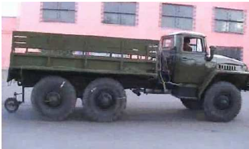
Рисунок 2.14 – Тривісний автомобіль Урал-4320 стандартної комплектації, оснащений апаратурою для реєстрування даних
