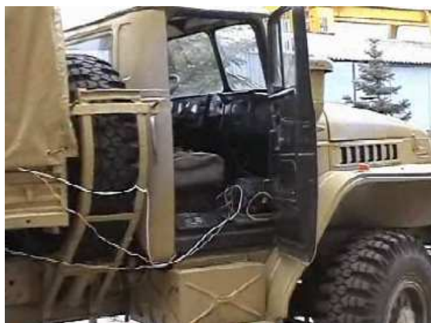
Рисунок 2.20 – Розводка датчиків на автомобілі, що випробовується
