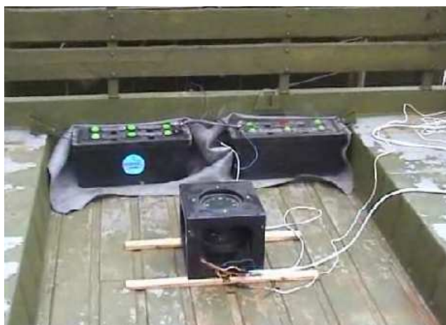
Рисунок 2.17 – Установка гіронапівкомпасу, закріпленого в спеціальному корпусі, в центральній частині кузова автомобіля
