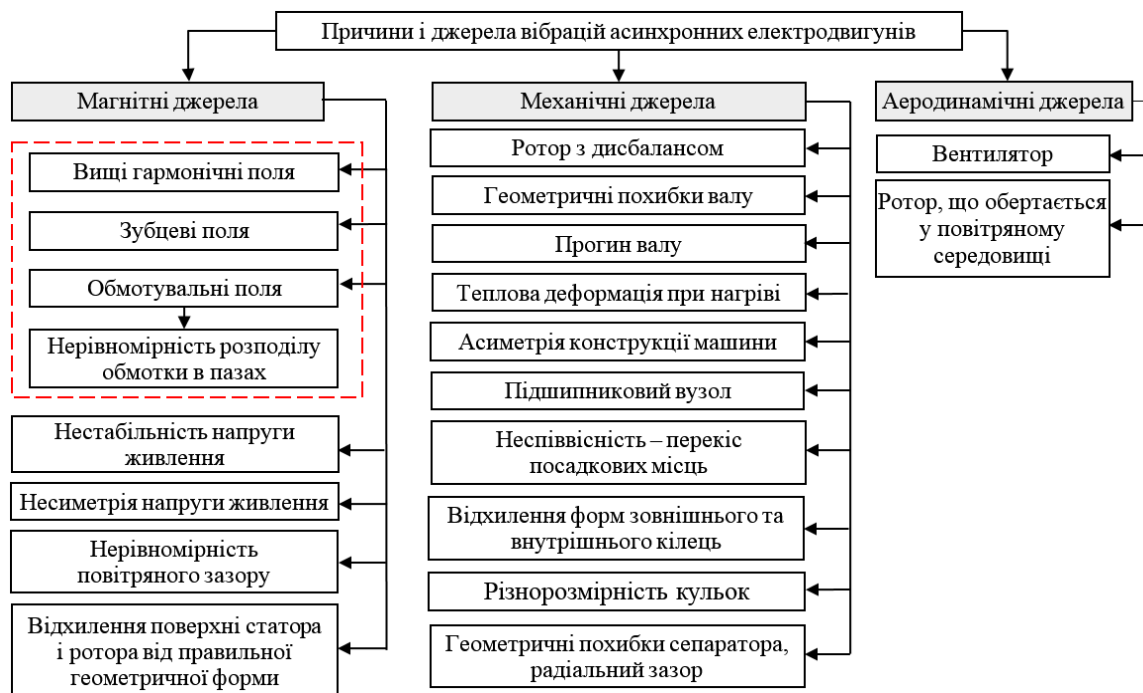
Рисунок 4.4 – Причини і джерела вібрації асинхронних електродвигунів
