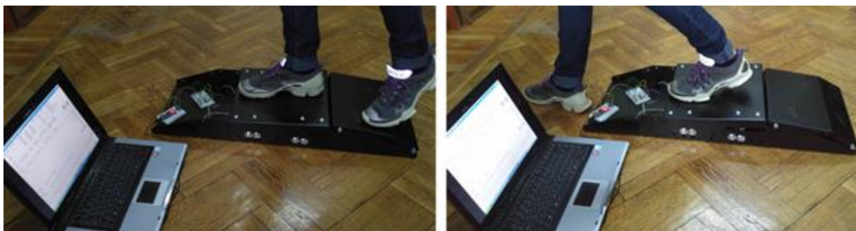
Рисунок 3.28 – Експериментальні дослідження енергогенеруючої платформи
