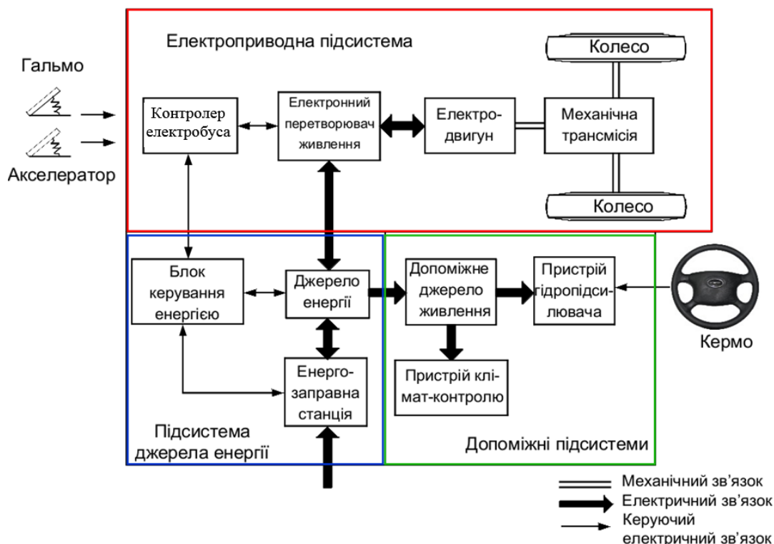
Рисунок 2.2 – Схематичне зображення загальної конфігурації електробуса
