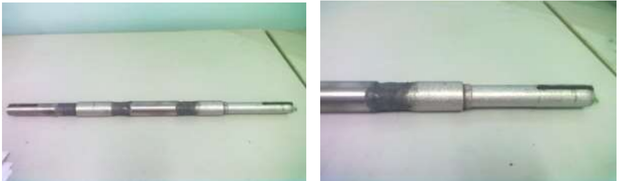
Рисунок 6.17 – Поверхні валу насосу, що не підлягають напиленню з нанесеною захисною пастою
