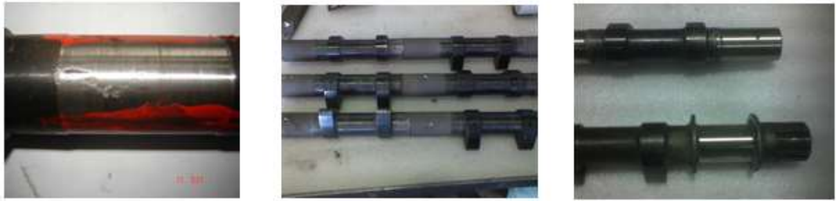
Рисунок 6.13 – Відновлені шийки валів: а – зношена шийка; б – відновлені шийки після напилення; в – відновлена шийка після фінішної обробки ПА
