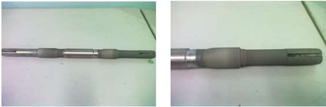
Рисунок 6.18 – Відновлені поверхні валу насосу
