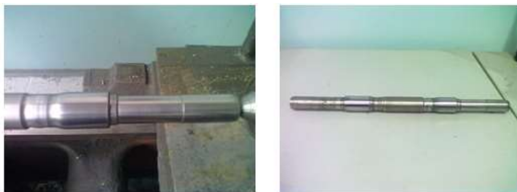
Рисунок 6.19 – Відновлені поверхні вала з покриттям після остаточної обробки іонним азотуванням в імпульсному режимі
