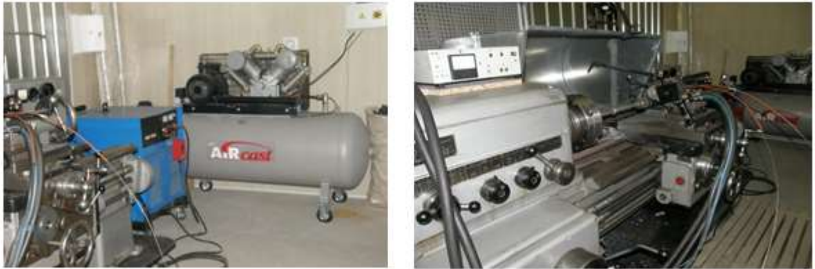
Рисунок 6.7 – Апарат для електродугового напилення ЕДН – 10 з джерелом постійного струму ВДУ-506, з дротами і комутуючою коробкою (а), і пультом управління (б).
