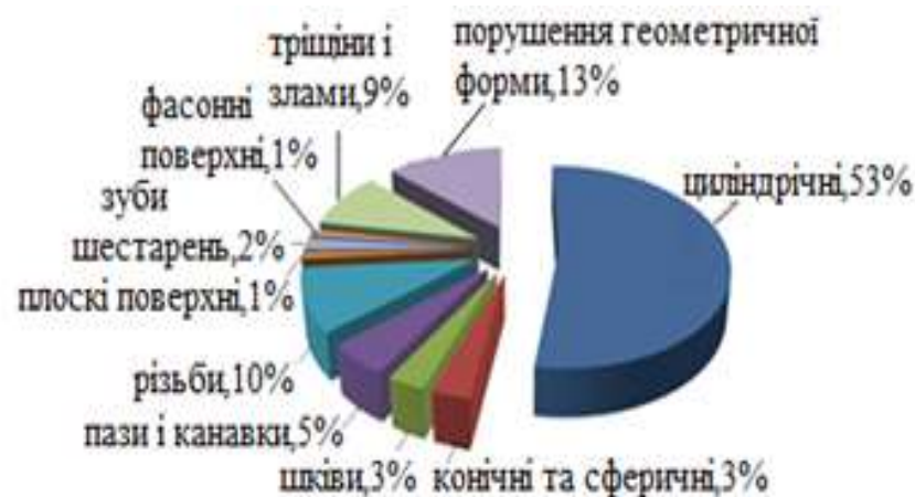
Рисунок 1.2 – Розподіл поверхонь деталей ЗТ за видами зносу
