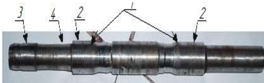
Рисунок 6.15 – Зношені поверхні вала Н13.550.51.150 вихрового консольного ступеневої насоса ВКС2 / 26, що підлягають відновленню: 1 – під підшипник; 2 – під ущільнення кришки підшипника; 3 – під робоче колесо; 4 – під сальникове ущільнення
