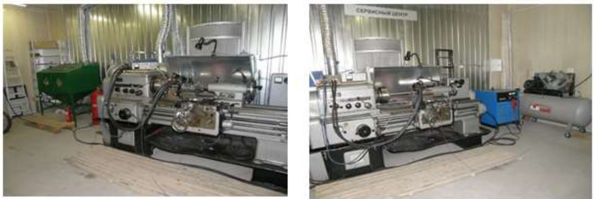
Рисунок 6.9 – Ділянка відновлення деталей ЗТ електродуговим методом нанесення покриттів
