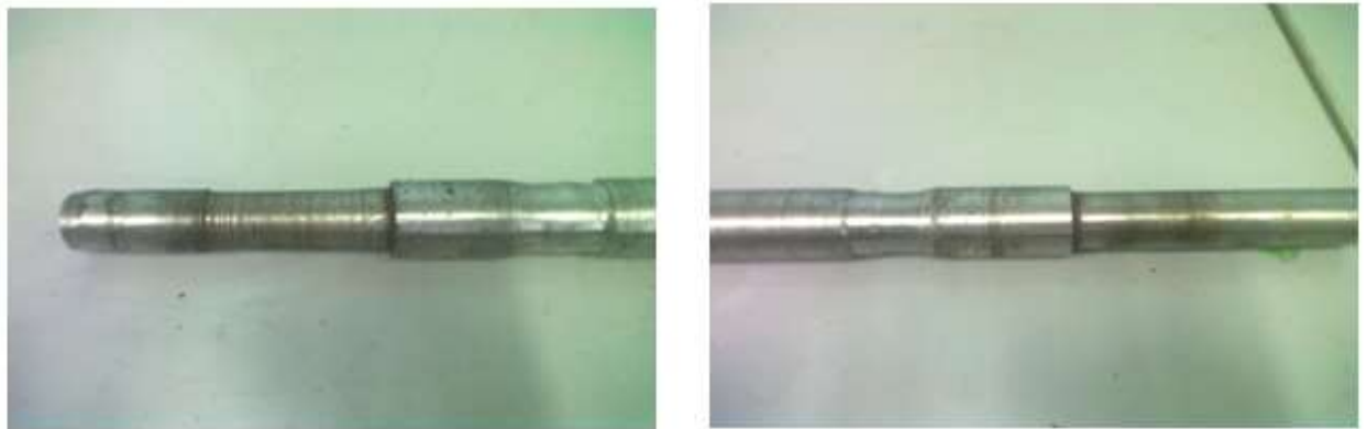
Рисунок 6.14 – Зношені поверхні вала Н13.550.51.150 насоса ВКС 2/26
