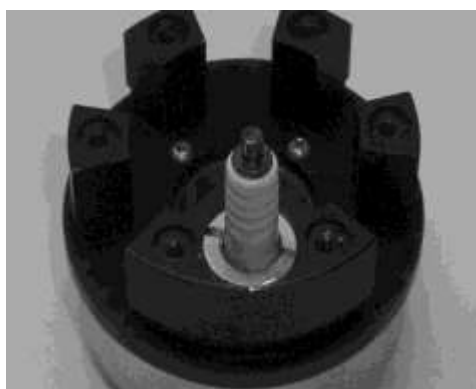
Рисунок Д.3 – Кріплення свічки запалювання в розподільнику камери згорання
