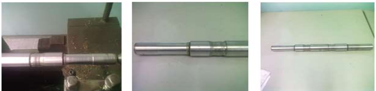
Рисунок 6.16 – Попередня механічна обробка зношених поверхонь валу
