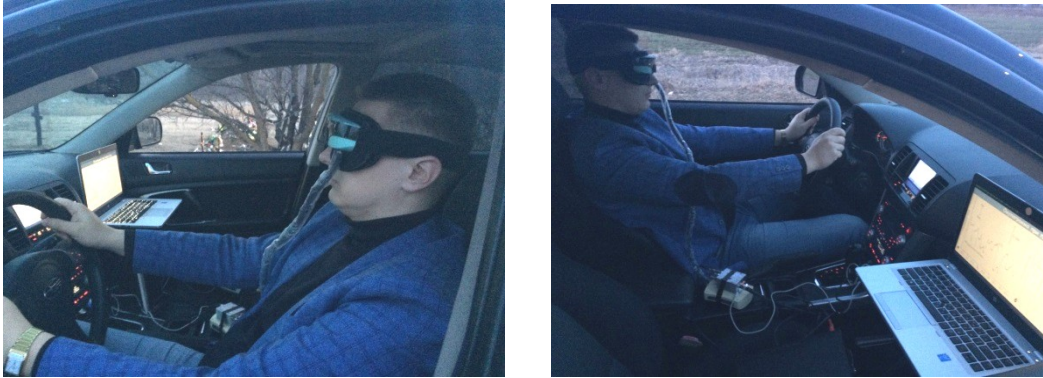
Рисунок 6 – Дослідження зорового сприйняття об'єктів водієм АТЗ у транспортному процесі за допомогою мобільного обладнання для окулографії
