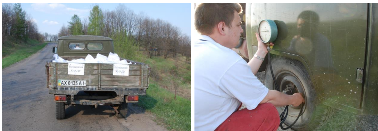
Рисунок 4 – Зміна варійованих параметрів у процесі проведення експериментальних досліджень: а – маси вантажу; б – тиску в шинах
