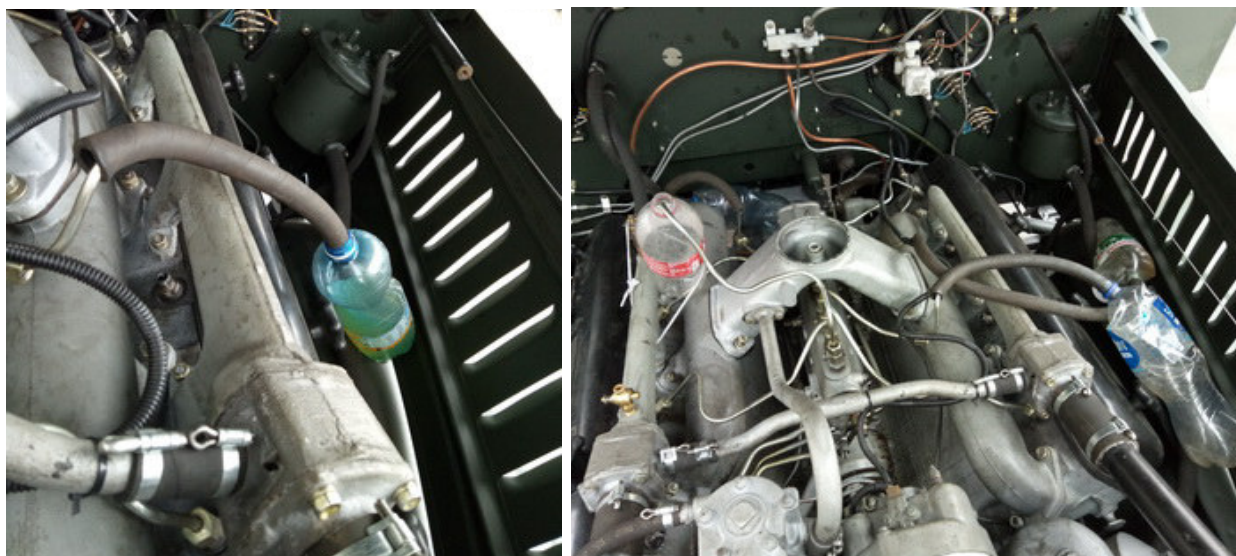
а – відключення двох циліндрів; б – відключення чотирьох циліндрів Рисунок 5 – Відключення подачі палива до циліндрів двигуна автомобіля КрАЗ-255Б
