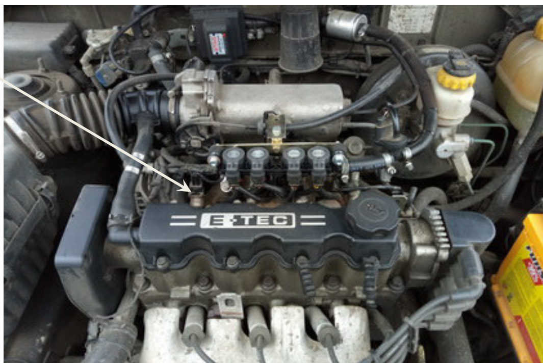
Рисунок 4 – Відключення подачі палива до циліндра двигуна автомобіля Daewoo Lanos 1.5i
