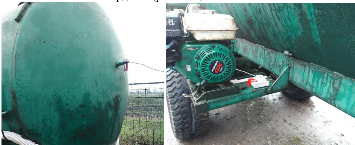
Рисунок 13 – Встановлення двох акселерометрів на транспортно-технологічній машині МЖТ-10
