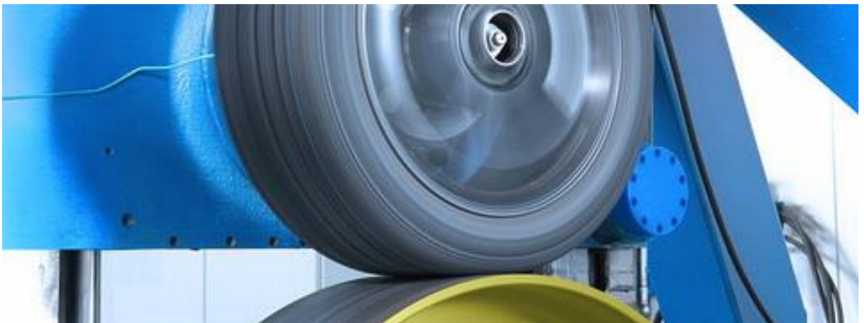
Рисунок 1.13 – Періодичні контрольні випробування серійного зразка автомобільної шини Dunlop SP Winter Sport 3D
