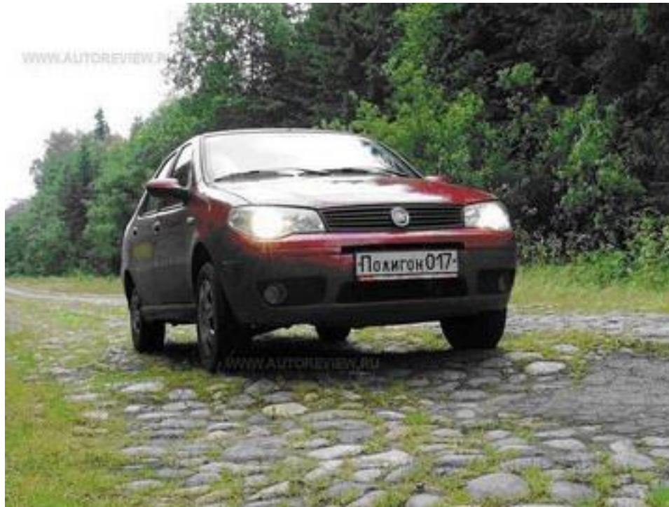
Рисунок 1.14 – Ресурсні випробування легкового автомобіля на бруковій дорозі
