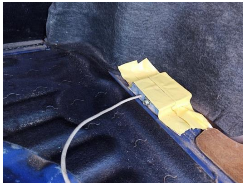
а – схема встановлення датчиків; б – місце кріплення датчиків прискорення в багажному відсіку автомобіля
