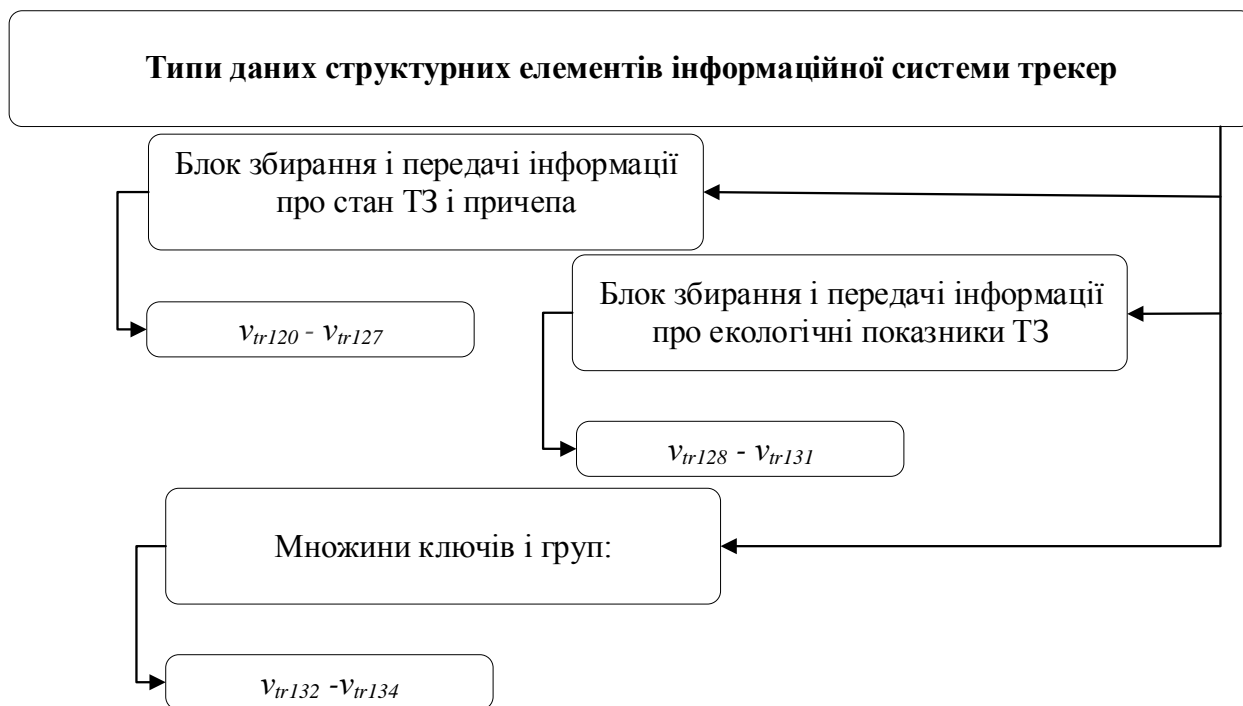
Рисунок 2.7 – Типи даних у блоках структурних елементів інформаційної системи моніторингу параметрів технічного стану ТЗ з встановленим трекером
