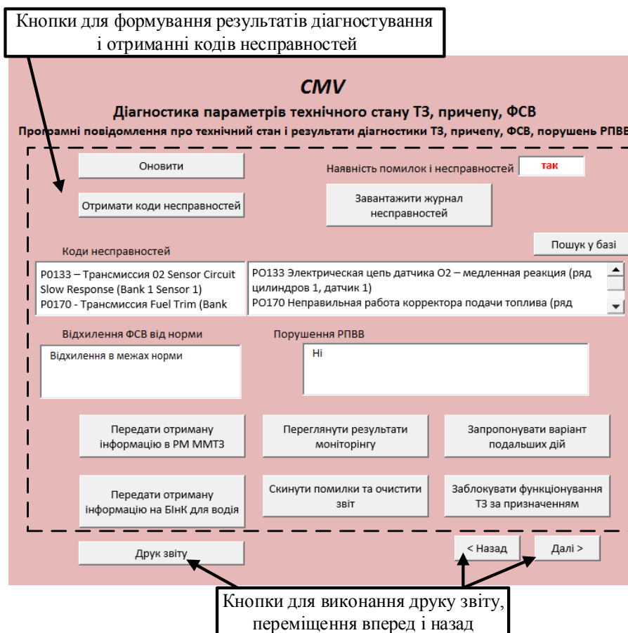
Рисунок 3.16 – Робоче вікно діагностики ТЗ в ІКК
