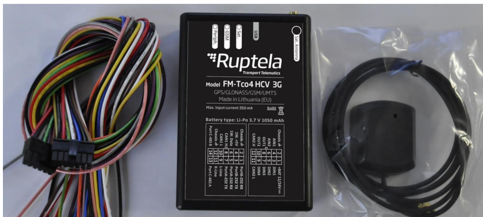
Рисунок 3.3 – Зовнішній вигляд передавального пристрою Ruptela FM-Tco4 HCV / HCV 3G
