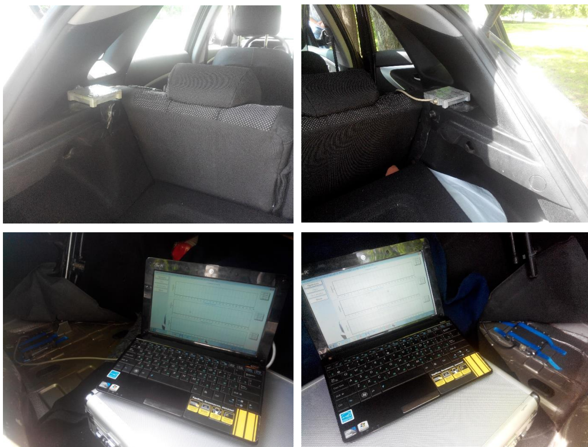
Рисунок 4.23 – Місця встановлення трьохосьових акселерометрів у випробуваних автомобілях
