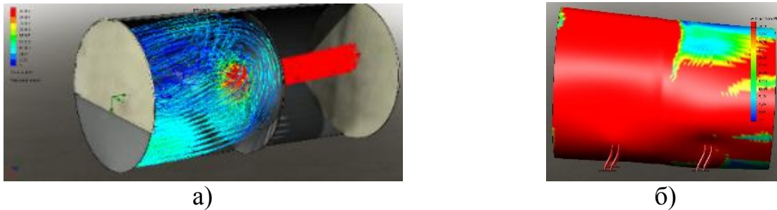
Рис. 17. Моделювання руху рідини в автоцистерні (а) і напруження (б), що виникають в оболонці котла цистерни
