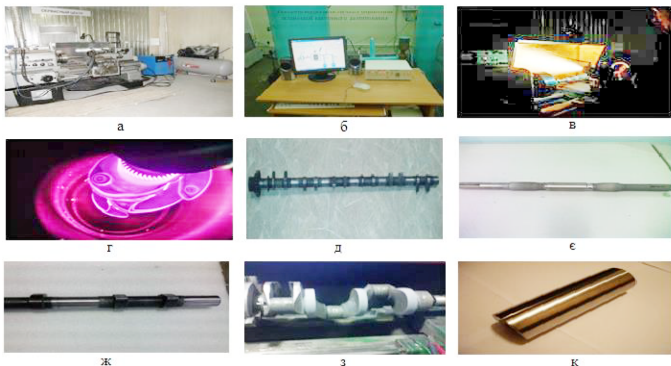
Рис. 19. Дільниця відновлення деталей ЗТ (а, б), процес ЕДН (в) і ПА (г); відновлені деталі: вал СДГ (д), вал СН (е), розподільний вал (ж), колінчастий вал (з) палець поршневий (к)
