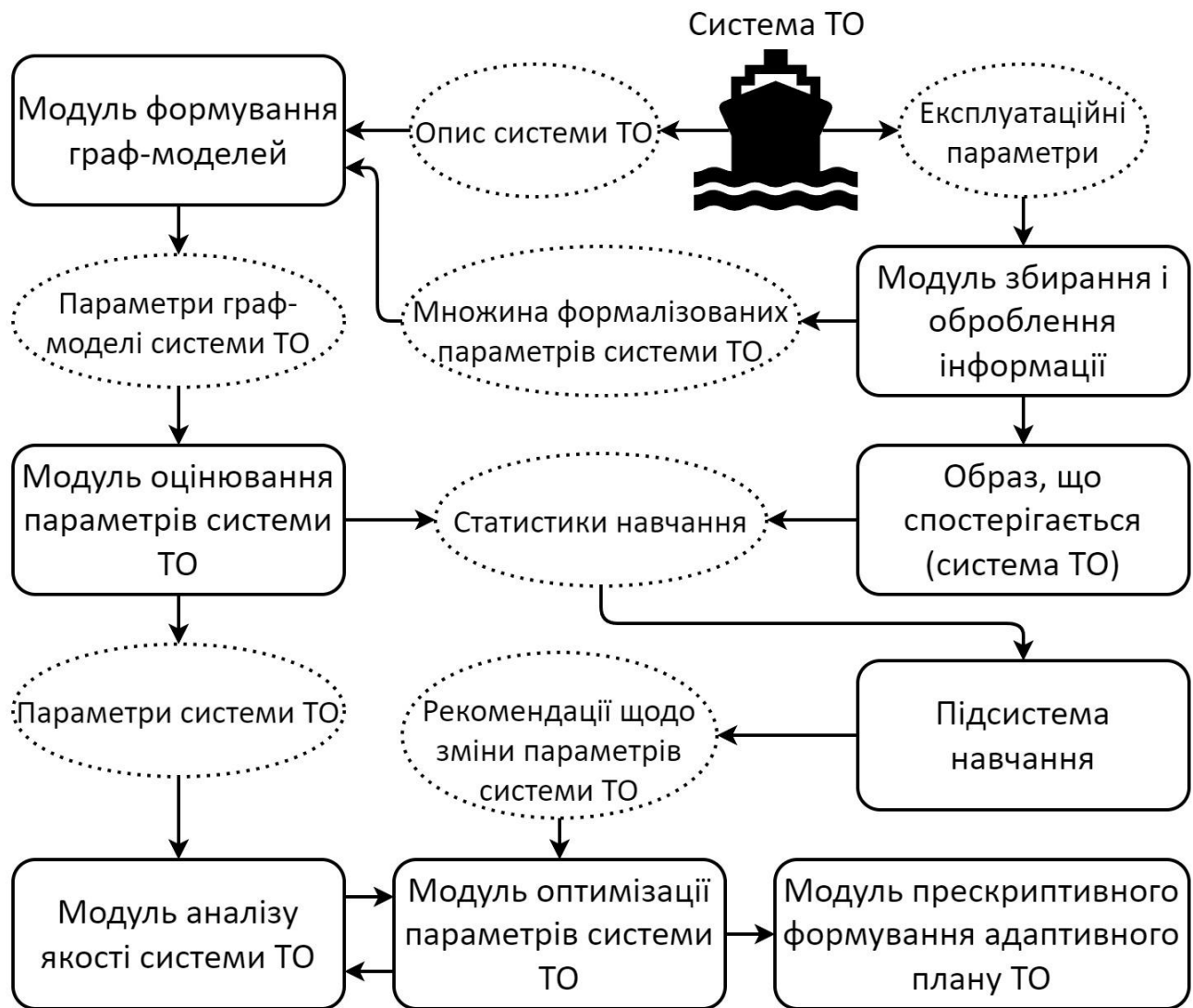
Рисунок 4 – Схема взаємозв'язків основних програмних модулів системи КПТОВС при керуванні якістю системи технічного обслуговування вантажного судна
