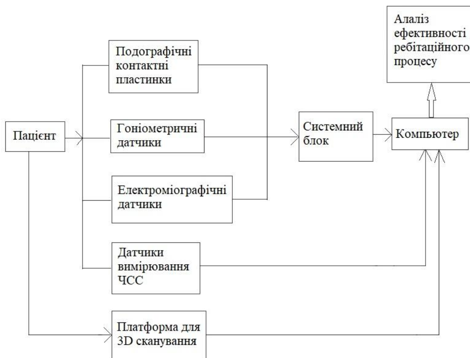
Рис. 1. Схема комплексної діагностики ОДА під час ходьби
