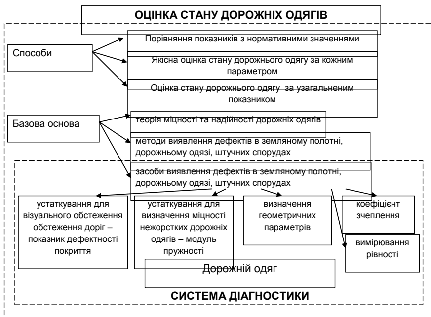
Рисунок 1 – Принципова схема оцінки стану дорожніх одягів
