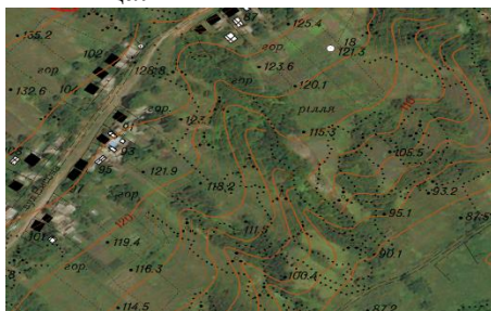
Рисунок 2 - Цифрова модель місцевості на космічному знімку (горизонталі проведені через 5м).
