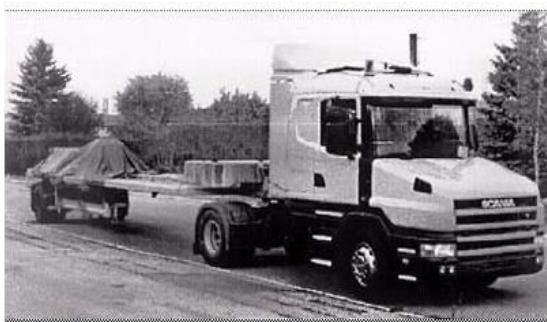
Рисунок 6 – Високошвидкісна установка вимірювання прогину (High Speed Deflectograph)
