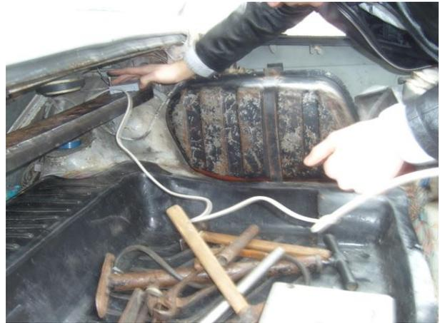
Рисунок 2.2 – Установка датчиків прискорень у багажнику випробовуваного автомобіля
