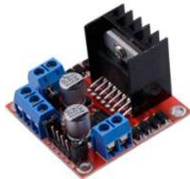
Рисунок 3.11 – Модуль для керування моторами на базі мікросхеми L298N
