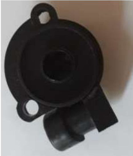
Рисунок 3.9 – Потенціометричний датчик кута повороту
