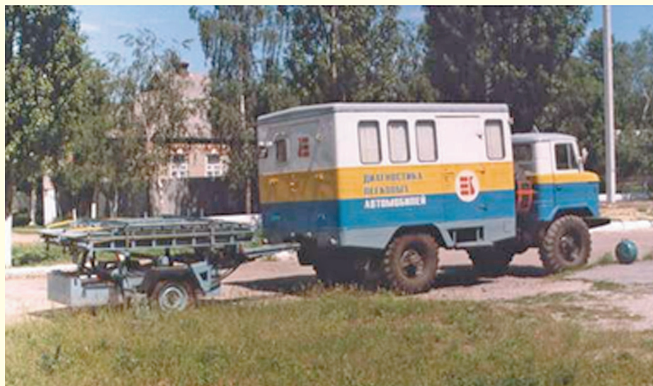
Пересувна станція діагностики ПДС-Л (1995 р.)
