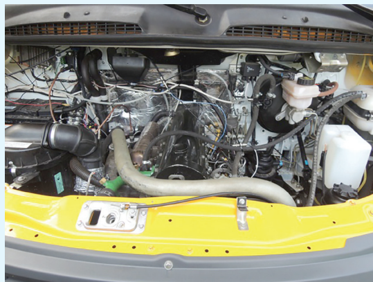
Дизель 4ДТНА1 у вітчизняному мікроавтобусі РУТА 25d
