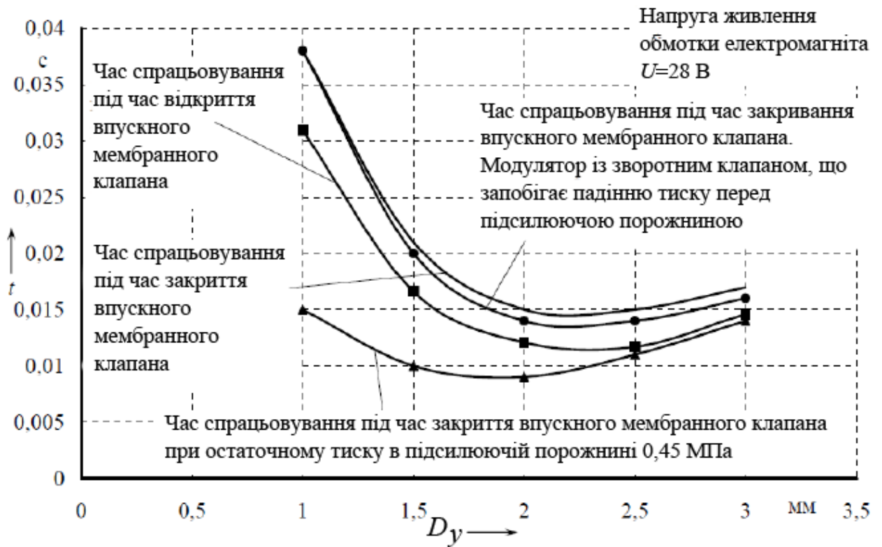
Рисунок 2.50 – Час спрацювання впускного мембранного клапана залежно від діаметра електромагнітного клапана
