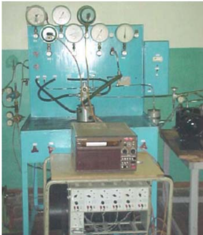
Рисунок 3.31 – Пристрій для випробування РГС із функціями повітророзподільного клапана в стендових умовах
