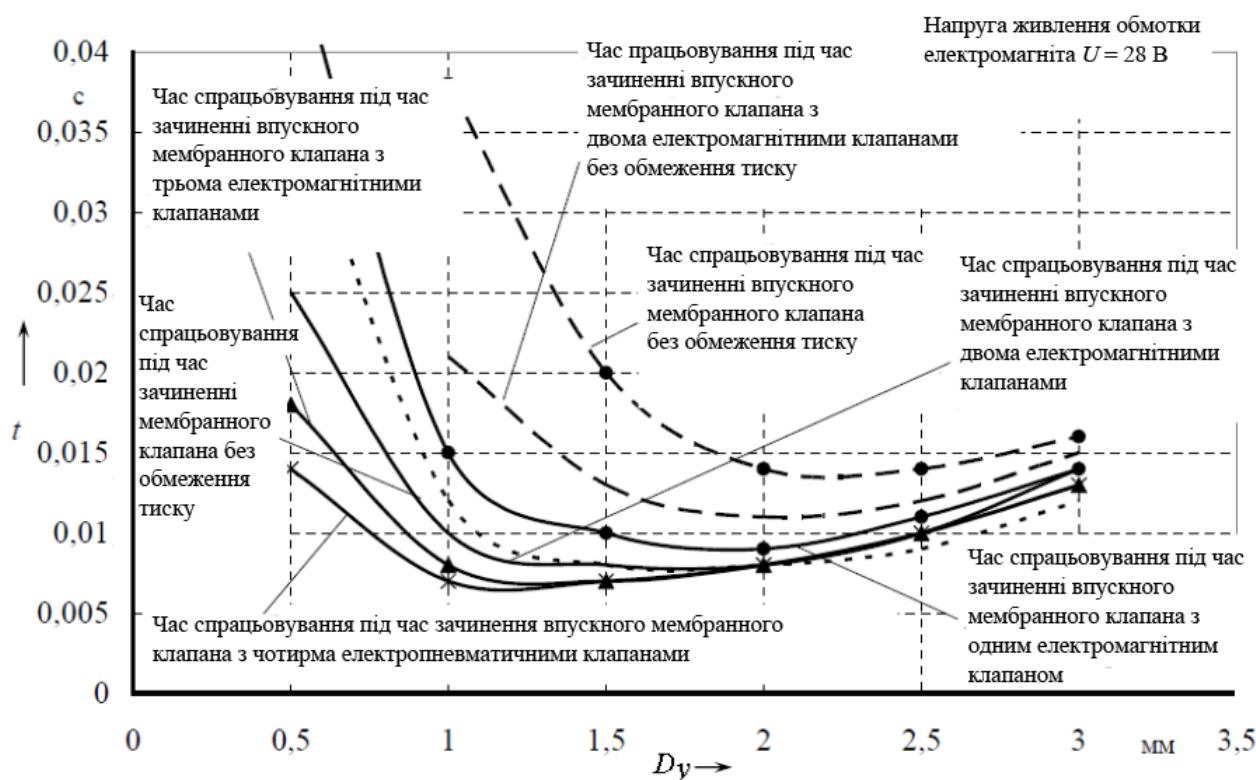
Рисунок 2.54 – Час спрацьовування впускного мембранного клапана при обмеженні мінімального тиску у підсилюючій порожнині до 4,5 \cdot 10^5 Па
