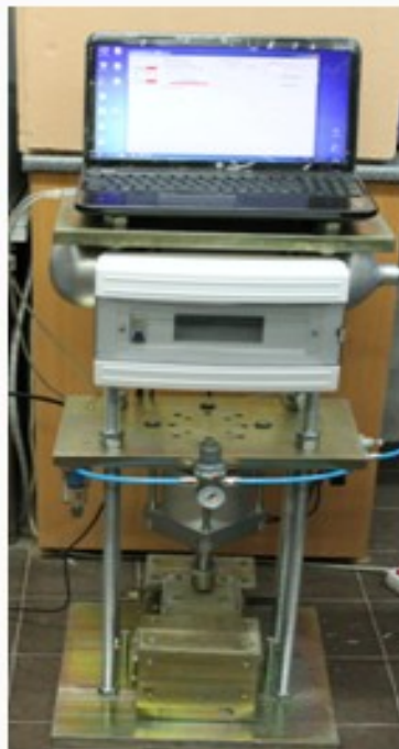
Рис. 4.2.9 Комплект устаткування для визначення в'язко-пружних характеристик асфальтобетонів
