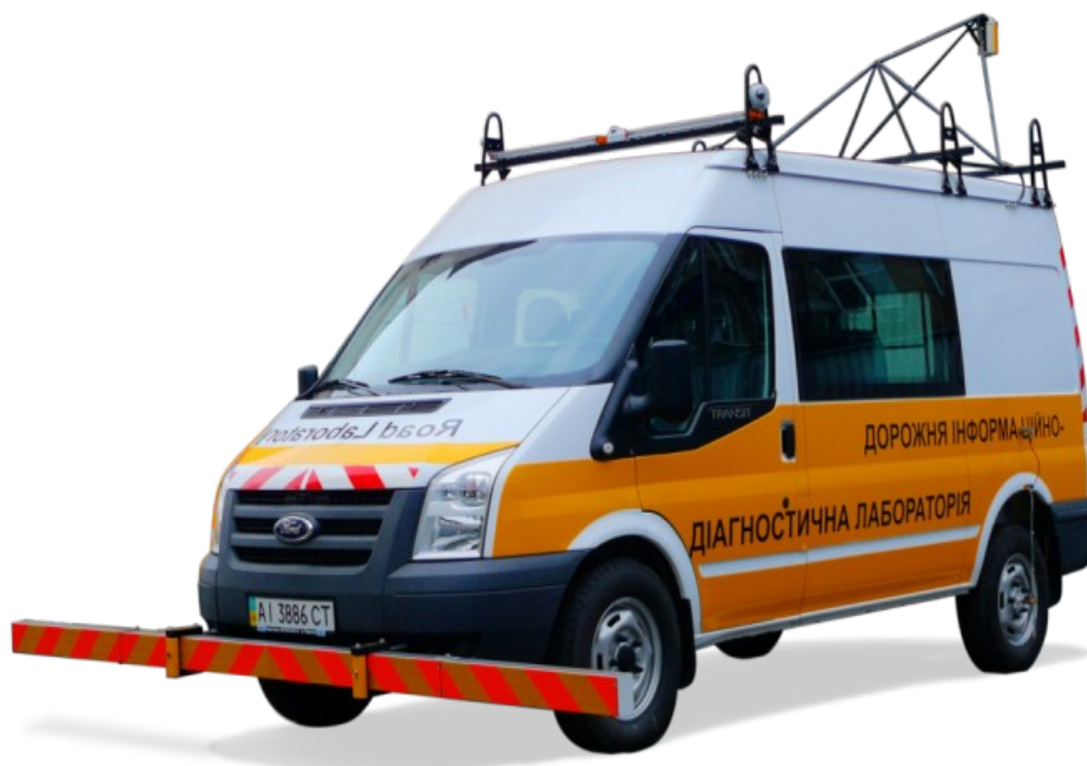
Рис. 4.4.3 Дорожня інформаційно-діагностична лабораторія
