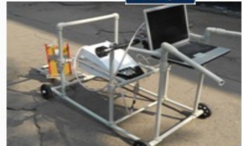
Рис. 2.4.15 Вимірювальний комплекс для георадарного дослідження дорожніх одягів
